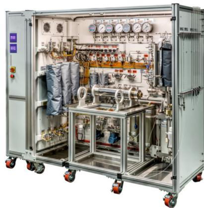
РЕГИСТРАЦИЯ ДАННЫХ ПРОЦЕССОВ ФИЛЬТРАЦИИ С ГРАФИЧЕСКИМ ВЫВОДОМ РАСХОДОВ ФЛЮИДОВ, ПЕРЕПАДА ДАВЛЕНИЙ И ДАННЫХ ПО ТЕМПЕРАТУРЕ
